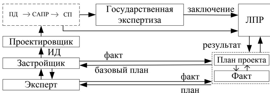
**Рис.4.** Логическая схема автоматизированной системы управления инвестиционно-строительным проектом
